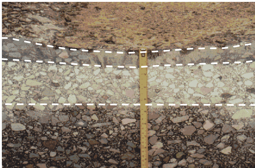
Figur 2. Spårbildning i slitlager (APA, 2004).
